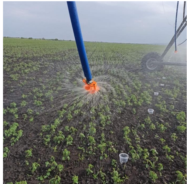
Рисунок 3.10 – Схема расстановки дождемеров для оценки равномерности полива ДМ «Каскад» («Кубань-ЛК1») и радиусов для определения площади полива под i -м дождемером
