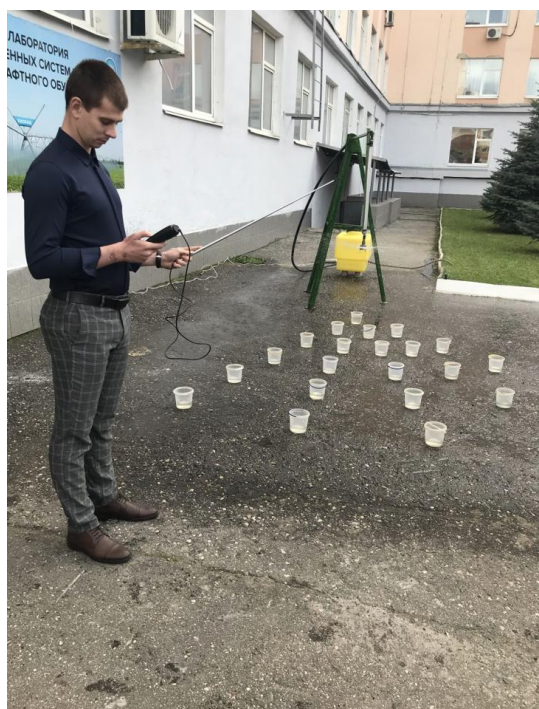
Рисунок 3.9 – Замер скорости ветра с помощью прибора Testo 425
