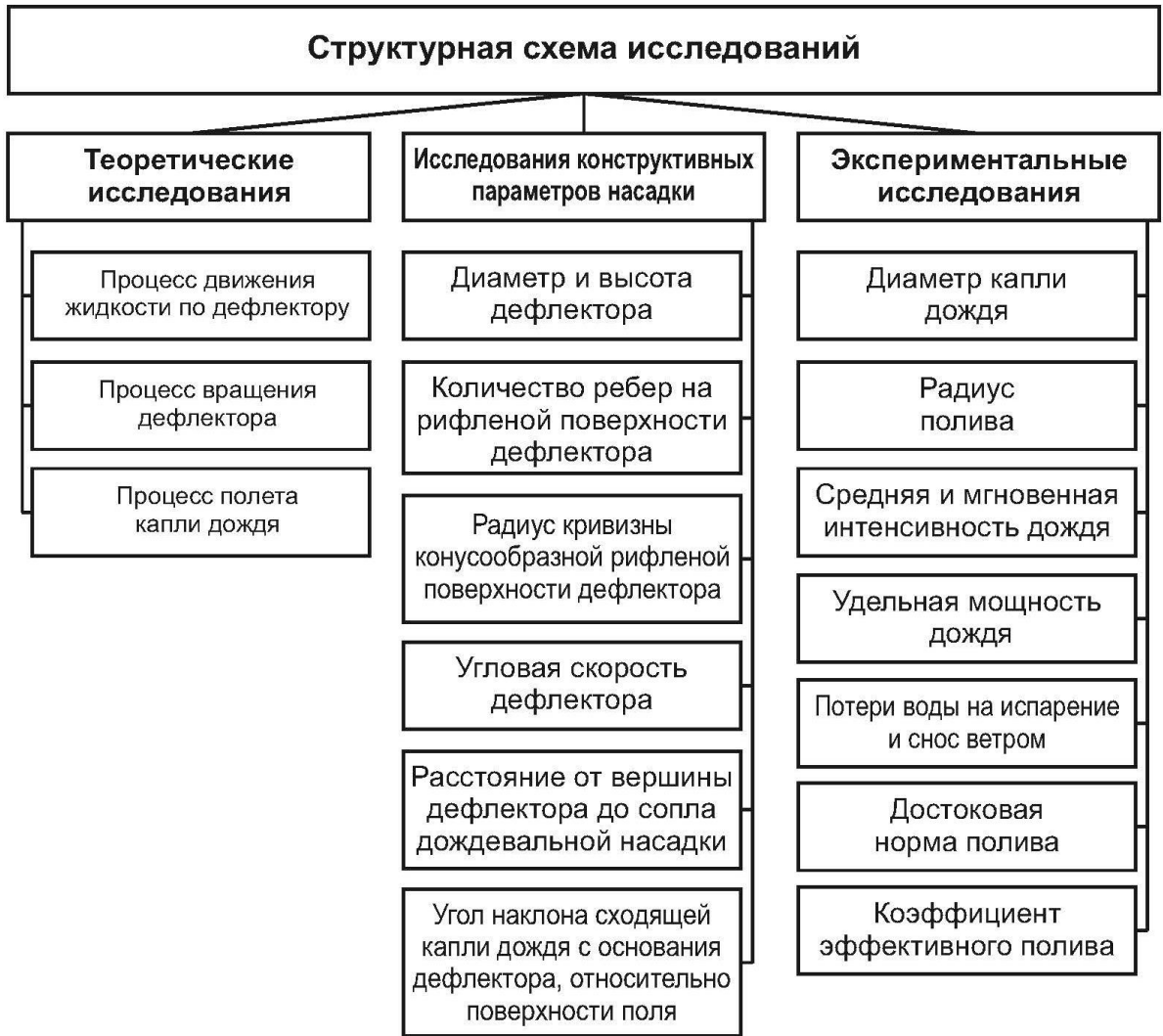
Рисунок 1.21 – Структурная схема исследований, направленных на повышение качественных показателей дождя
