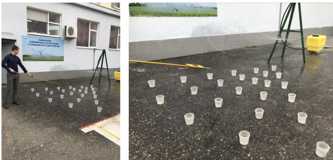
Рисунок 3.7 – Замер диаметра капель дождя
