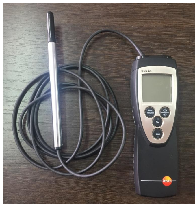
Рисунок 3.9 – Замер скорости ветра с помощью прибора Testo 425
