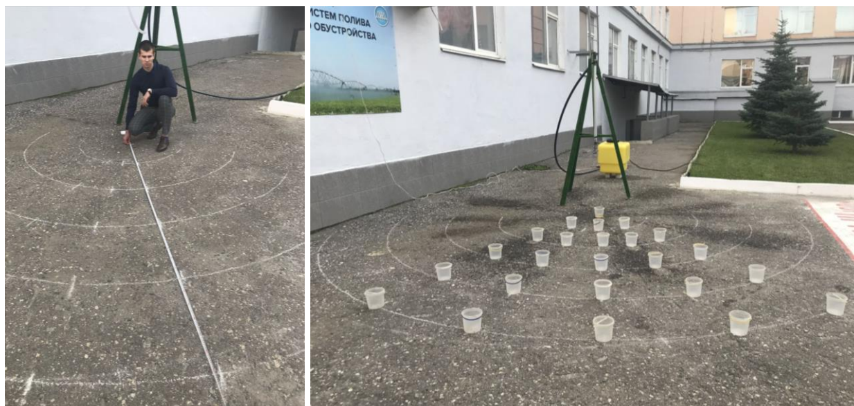
Рисунок 3.2 – Разбивка участка для установки дождемеров
