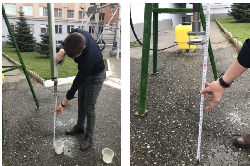
Рисунок 3.4 – Замер высоты установки дождевальной насадки относительно дневной поверхности
