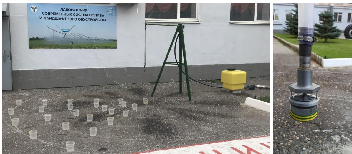
Рисунок 3.1 – Общий вид экспериментальной установки с исследуемой дождевальными насадкой
