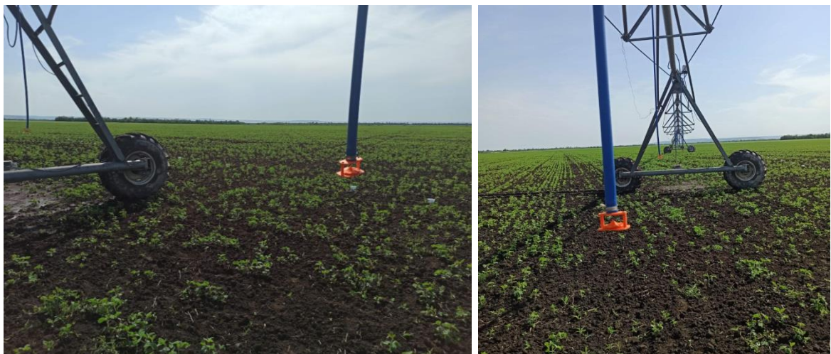
Рисунок 5.1 – Производственные испытания дождевальной машины, оборудованной дождевальными насадками с вращающимся дефлектором конусообразной формы с рифленой поверхностью
